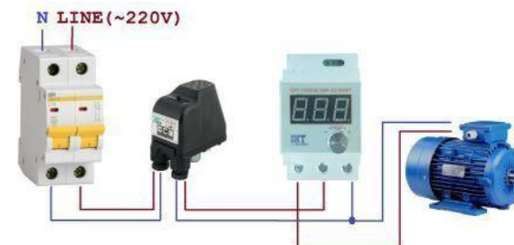
мал. 4 Можлива схема підключення при автоматичному режимі
