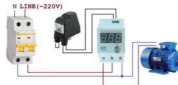
мал. 5 Можлива схема підключення при дистанційному режимі
